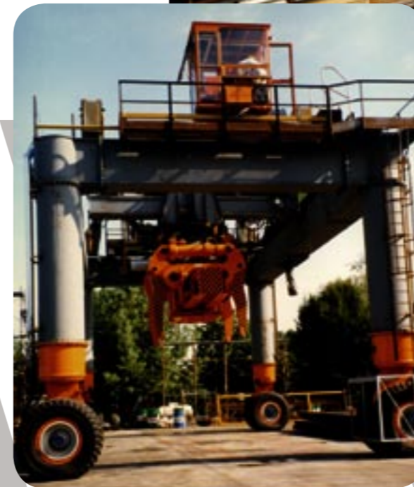
I Pinza a stretta idraulica per bramme con tastatore UK Slabs tong with hydraulic clamping with adjustable table F Pince à brames avec prise hydraulique et palpeur réglable D Brammenzange mit hydraulischem Zangenantrieb und Greifweiteneinstellung
