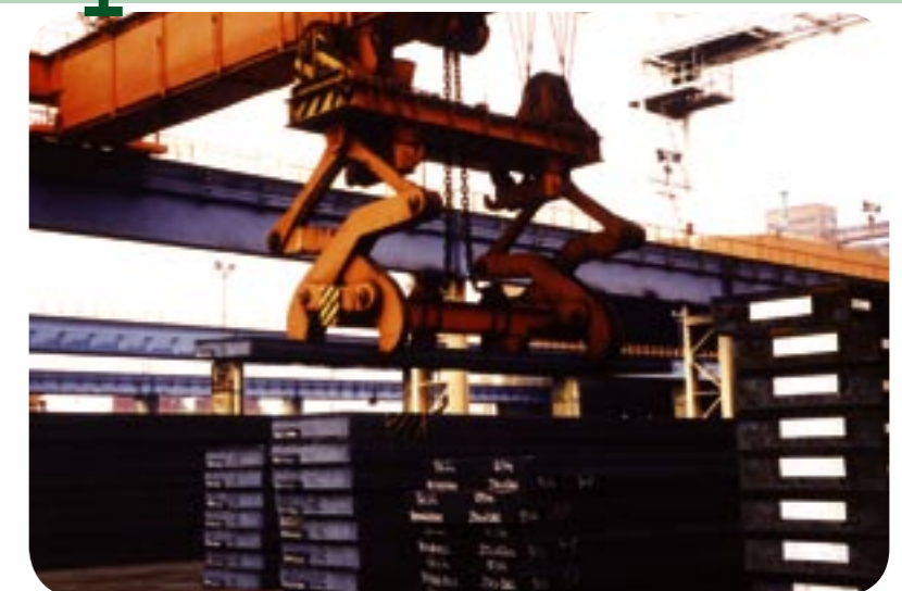
I Pinza motorizzata per bramme con argano ausiliario del carro ponte UK Motorized slabs tong with auxiliary hoist on crane F Pince motorisée à brames avec auxiliaire treuil sur le pont roulant D Brammenzange, motorisch angetrieben, mit Winde auf Laufkran
