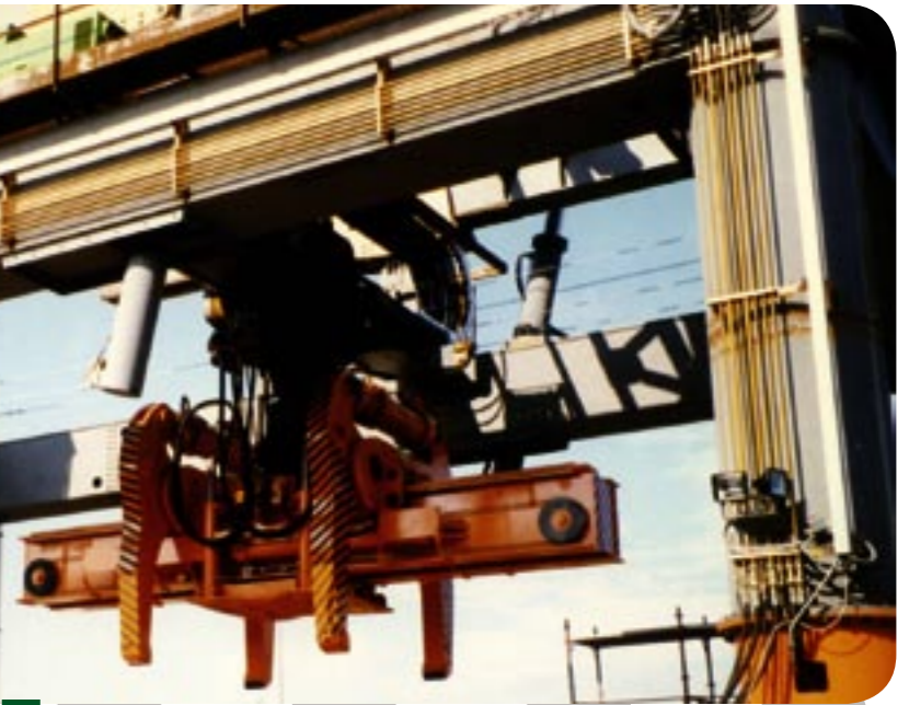
I Pinza a stretta idraulica per bramme con tastatore UK Slabs tong with hydraulic clamping with adjustable table F Pince à brames avec prise hydraulique et palpeur réglable D Brammenzange mit hydraulischem Zangenantrieb und Greifweiteneinstellung
